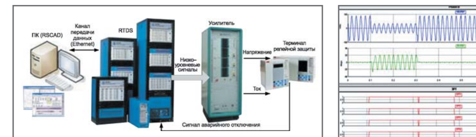
Исследование работы терминала дистанционной защиты линии 110 кВ с использованием комплекса RTDS: а – структурная схема комплекса при проведении испытаний; б – графики изменения напряжения и тока (для одной из фаз) в месте установки защиты, дискретных сигналов от терминала
